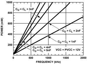
FIGURE 1. POWER DISSIPATION vs FREQUENCY
