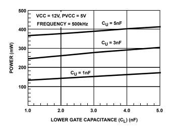
FIGURE 8. POWER DISSIPATION vs LOWER GATE
