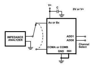
FIGURE 6. CAPACITANCE TEST CIRCUIT
