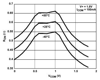
FIGURE 10. ON RESISTANCE vs SWITCH VOLTAGE
