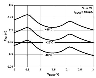
FIGURE 9. ON RESISTANCE vs SWITCH VOLTAGE
