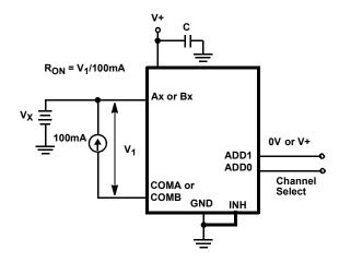
FIGURE 4. RON TEST CIRCUIT
