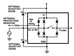
FIGURE 7. OVERVOLTAGE PROTECTION
