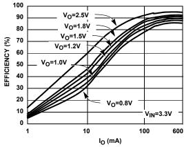
FIGURE 4. EFFICIENCY vs IO (PWM MODE)
