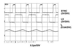
FIGURE 14. EXTERNAL SYNCHRONIZATION TO 2MHz
