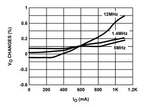
FIGURE 20. LOAD REGULATION (PWM MODE)
