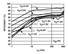
FIGURE 1. EFFICIENCY vs IO (PFM/PWM MODE)
