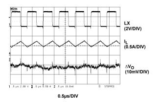
FIGURE 13. PWM STEADY-STATE OPERATION (IO = 600mA)
