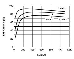
FIGURE 19. EFFICIENCY vs I<sub>O</sub> (PWM MODE)
