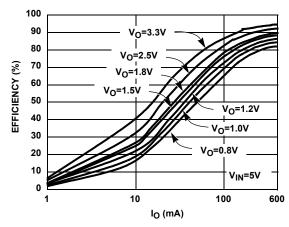
FIGURE 2. EFFICIENCY vs I<sub>O</sub> (PWM MODE)
