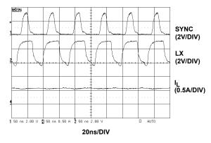
FIGURE 15. EXTERNAL SYNCHRONIZATION TO 12MHz
