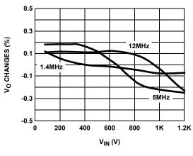
FIGURE 21. LINE REGULATION @ 500mA (PWM MODE)
