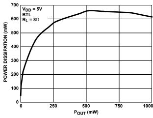
FIGURE 8. POWER DISSIPATION vs OUTPUT POWER
