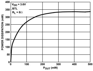
FIGURE 9. POWER DISSIPATION vs OUTPUT POWER
