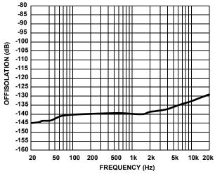
FIGURE 6. OFFISOLATION vs FREQUENCY
