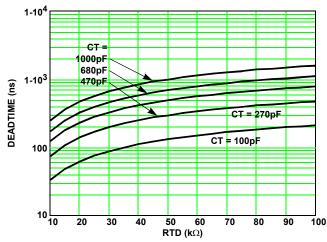
FIGURE 2. DEADTIME vs CAPACITANCE
