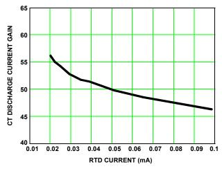
FIGURE 1. OSCILLATOR CT DISCHARGE CURRENT GAIN
