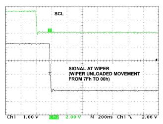
FIGURE 14. LARGE SIGNAL SETTLING TIME
