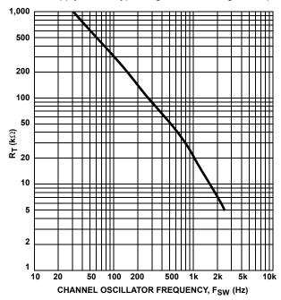
FIGURE 12. RESISTANCE R<sub>T</sub> vs FREQUENCY
