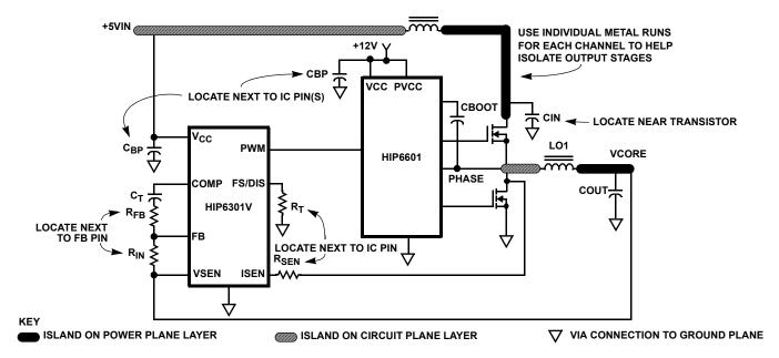
FIGURE 13. PRINTED CIRCUIT BOARD POWER PLANES AND ISLANDS
