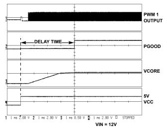
FIGURE 3. START-UP OF 4-PHASE SYSTEM OPERATING AT 500kHz
