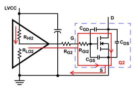
FIGURE 4. TYPICAL LOWER-GATE DRIVE TURN-ON PATH
