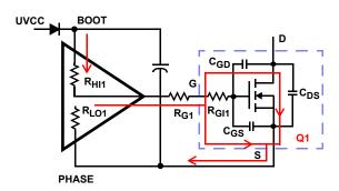
FIGURE 3. TYPICAL UPPER-GATE DRIVE TURN-ON PATH
