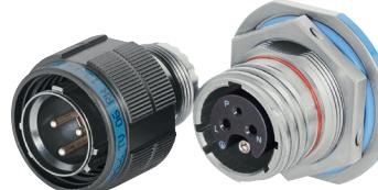
Power-Steckverbinder, geschirmt, mit Schaltleistung für 250/500V Anwendungen mit Schutzleiter, zugelassen nach VG96944 und VDE EN 61984 (VDE 0627). Tri-Start Schraubkupplung und Gehäuse nach MIL-DTL-38999 III
