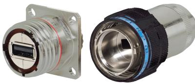
Miniatur USB Rundsteckverbinder, geschirmt, für Datenübertragung bis 5 Gbit/s (USB 3.0) in Größe 15. Vibrationsfeste Tri-Start Schraubkupplung nach MIL-DTL-38999 III.
