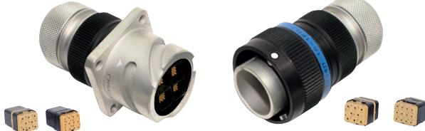
Modular Reverse Bajonett Rundsteckverbinder, geschirmt, in Gehäusegröße 32 nach VG95234, Aufnahme von bis zu 4 Kontakteinsätzen aus VG96513 für elektrische und optische Kontakte (MT, MPO, Lumière, ARINC801), sowie RJ45, Koax-, Triax-, Twinax- und Quadrax-Kontakte.
