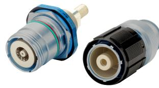
Einpoliger Hochstromsteckverbinder, geschirmt, für bis zu 875 VAC mit Tri-Start Schraubkupplung nach MIL-DTL-38999 Serie III, Gehäusegröße 13 bis 25.
