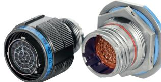
Miniatur Rundsteckverbinder, geschirmt, nach MIL-DTL-38999 III in Größe 9 bis 25. Vibrationsfeste Tri-Start Schraubkupplung. Baureihe mit sehr hohen Kontaktdichte und einem 100% Kontaktschutz.
