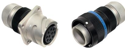
Robuste Reverse Bajonett Rundsteckverbinder, geschirmt, in Größe 10SL bis 36, bis 1 bar druckwasserdicht, verschleiß- und vibrationsfest, gut geeignet für rauhe Umgebungen.
