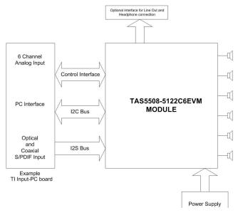
Figure 1-1. Complete PurePath Digital™ System
