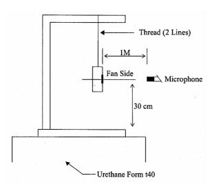
1 METER FROM MICROPHONE TO FAN INTAKE
