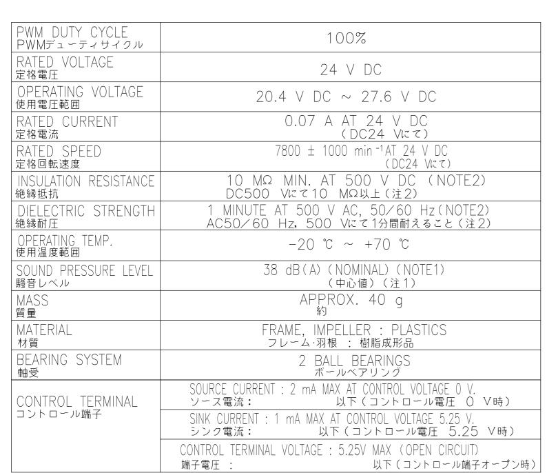
NOTE: 1. MEASURED AT 1 m DISTANCE FROM THE AIR INLET. ファン吸込側より1 mにて測定する。
