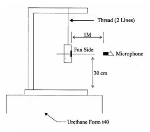
1 METER FROM MICROPHONE TO FAN INTAKE
