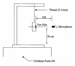
1 METER FROM MICROPHONE TO FAN INTAKE
