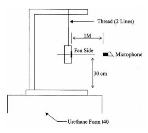
1 METER FROM MICROPHONE TO FAN INTAKE
