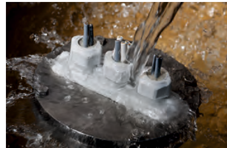
Fig. 2 – UNI Flange® en la prueba de protección contra el agua Fig. 2 – UNI Flange® in a water ingress test
