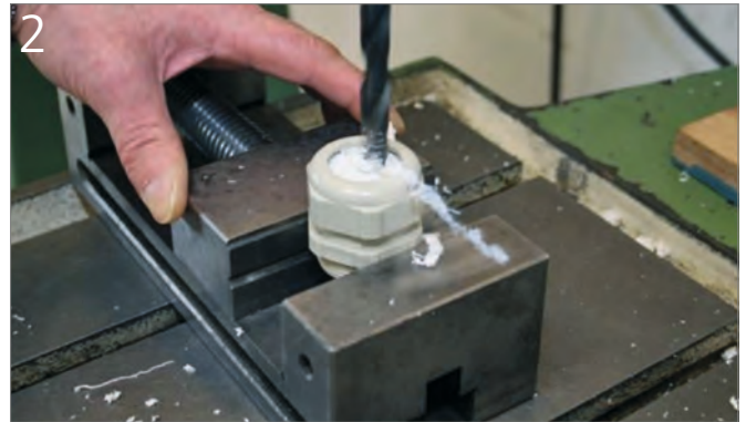
Colocar la broca en los puntos deseados. Trabajar a baja velocidad con una broca HSS.
