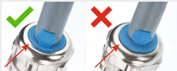
Fig. 1 – Apretar la cabeza del prensaestopas hasta que el inserto y la cabeza del prensaestopas estén al mismo nivel. Fig. 1 – Tighten pressure screw visual until pressure screw and sealing insert are at the same level.
