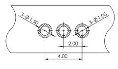
RECOMMENDED PCB LAYOUT (T:1.2mm) TOLERANCE UNSPECIFIED ±0.05mm
