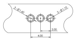
RECOMMENDED P.C.B. LAYOUT (T:1.2mm) TOLERANCE UNSPECIFIED ±0.05mm
