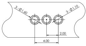
RECOMMENDED P.C.B. LAYOUT TOLERANCE UNSPECIFIED ±0.05mm
