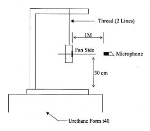
1 METER FROM MICROPHONE TO FAN INTAKE
