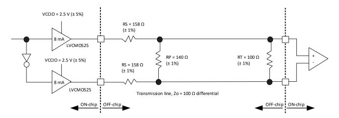
Figure 3.2. LVDS25E Output Termination Example
