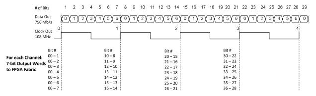
Figure 3.11. DDRX71 Video Timing Waveforms
