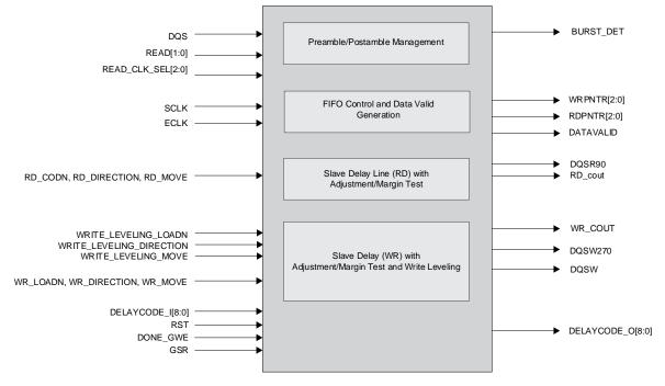
Figure 2.24. DQS Control and Delay Block (DQSBUF)
