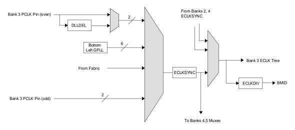
Figure 2.8. Edge Clock Sources per Bank
