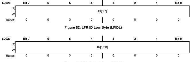
Figure 83. LFR ID High Byte (LFIDH)
