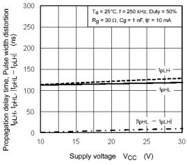
Fig. 12.2.13  $t_{pLH}$ , $t_{pHL}$ , $|t_{pHL}$ - $t_{pLH}|$  -  $V_{CC}$
