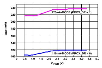
FIGURE 10. IRDR PULSE AMPLITUDE vs  $V_{IRDR}$
