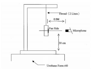
0.5 METER FROM MICROPHONE TO FAN INTAKE
