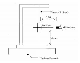
0.5 METER FROM MICROPHONE TO FAN INTAKE
