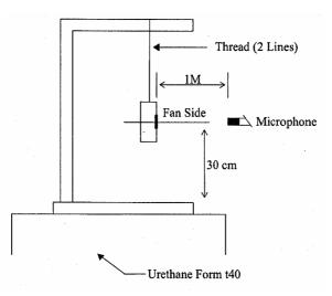
1 METER FROM MICROPHONE TO FAN INTAKE
