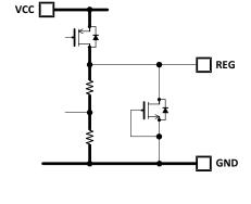
Figure 8. REG Equivalent Circuit
