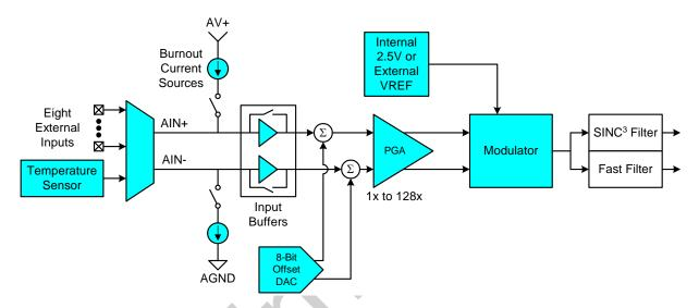
Figure 1.7. ADC0 Block Diagram
