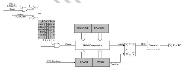
Figure 23.9. PCA 16-Bit PWM Mode
