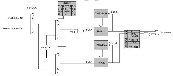
Figure 22.12. Timer 2 8-Bit Mode Block Diagram
