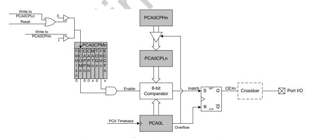
Figure 23.8. PCA 8-Bit PWM Mode Diagram
