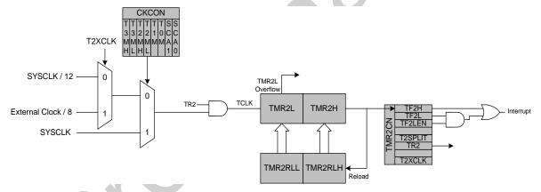
Figure 22.11. Timer 2 16-Bit Mode Block Diagram
