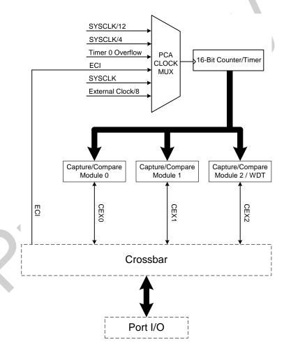
Figure 1.11. PCA Block Diagram
