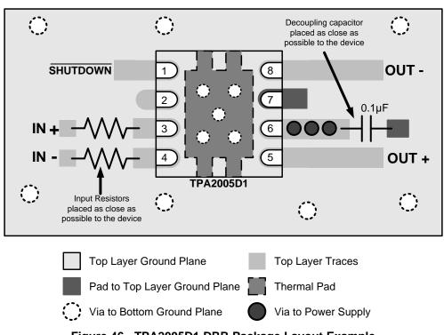
Figure 46. TPA2005D1 DRB Package Layout Example
