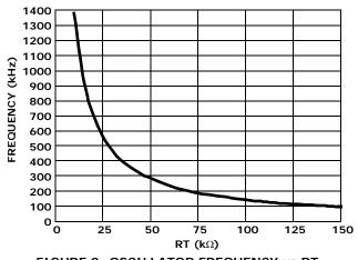
FIGURE 8. OSCILLATOR FREQUENCY vs RT
