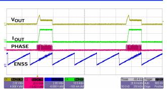
FIGURE 10. TYPICAL OVERCURRENT HICCUP MODE
