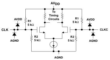
Figure 20. Clock Inputs
