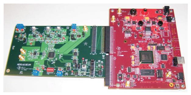
Figure 2. TSW1100 and ADS1610EVM Setup
