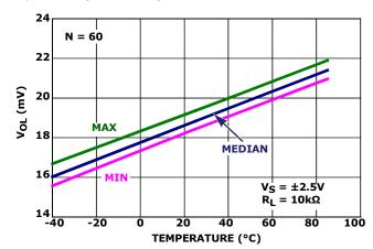
FIGURE 31. V<sub>OL</sub> vs TEMPERATURE
