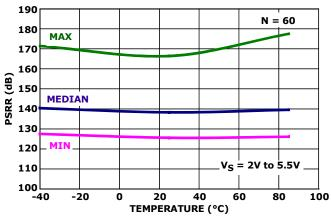
FIGURE 26. PSRR vs TEMPERATURE
