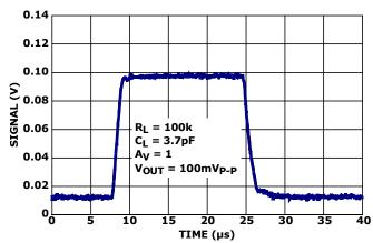
FIGURE 29. SMALL SIGNAL STEP RESPONSE (100mV)
