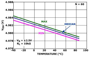
FIGURE 30. V<sub>OH</sub> vs TEMPERATURE
