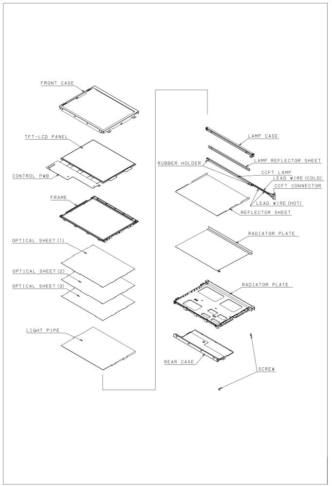
FIG. 2 MODULE CONFIGURATION
