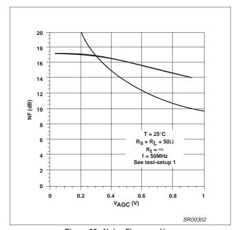
Figure 30. Noise Figure vs  $V_{AGC}$
