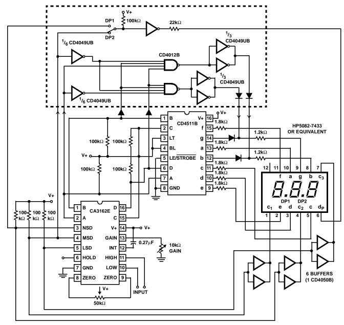
FIGURE 4. TYPICAL COMMON-CATHODE LED APPLICATION
