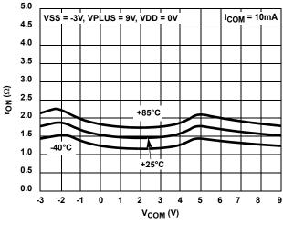
FIGURE 13. ON-RESISTANCE vs SWITCH VOLTAGE
