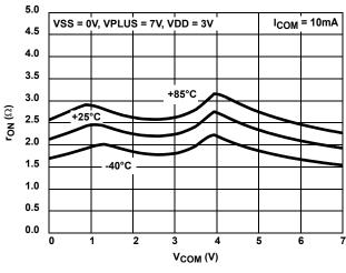
FIGURE 12. ON-RESISTANCE vs SWITCH VOLTAGE
