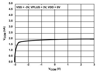
FIGURE 21. OFF-LEAKAGE vs SWITCH VOLTAGE
