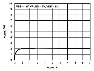
FIGURE 23. OFF-LEAKAGE vs SWITCH VOLTAGE
