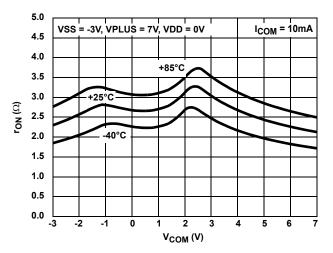
FIGURE 11. ON-RESISTANCE vs SWITCH VOLTAGE
