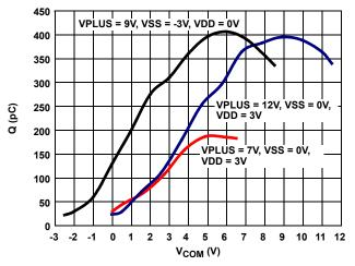
FIGURE 31. CHARGE INJECTION vs SWITCH VOLTAGE
