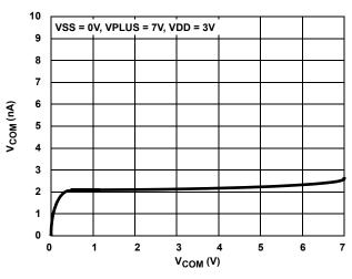
FIGURE 24. OFF-LEAKAGE vs SWITCH VOLTAGE
