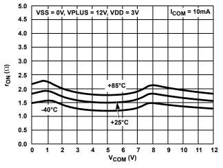
FIGURE 14. ON-RESISTANCE vs SWITCH VOLTAGE
