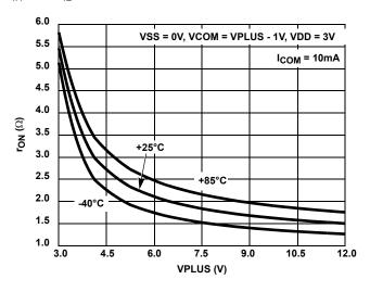
FIGURE 28. ON-RESISTANCE vs SUPPLY VOLTAGE
