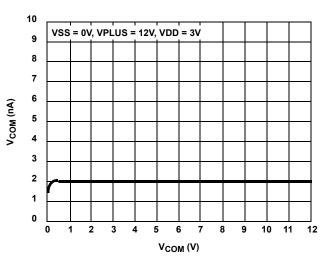
FIGURE 26. OFF-LEAKAGE vs SWITCH VOLTAGE
