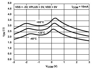
FIGURE 9. ON-RESISTANCE vs SWITCH VOLTAGE
