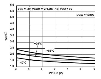
FIGURE 27. ON-RESISTANCE vs SUPPLY VOLTAGE
