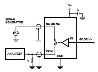
FIGURE 4. OFF-ISOLATION TEST CIRCUIT
