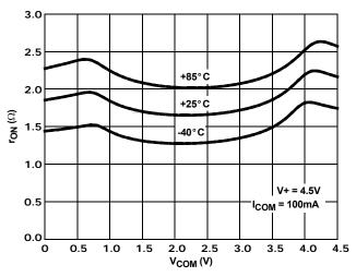
FIGURE 11. ON-RESISTANCE vs SWITCH VOLTAGE
