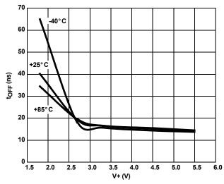
FIGURE 15. TURN-OFF TIME vs SUPPLY VOLTAGE
