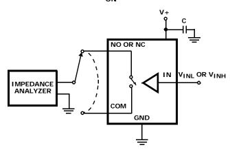
FIGURE 7. CAPACITANCE TEST CIRCUIT
