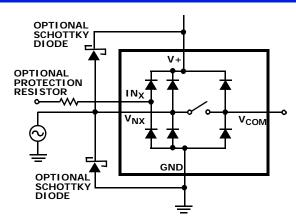
FIGURE 9. OVERVOLTAGE PROTECTION
