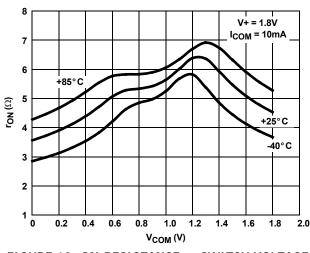
FIGURE 13. ON-RESISTANCE vs SWITCH VOLTAGE
