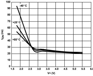
FIGURE 14. TURN-ON TIME vs SUPPLY VOLTAGE
