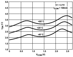
FIGURE 12. ON-RESISTANCE vs SWITCH VOLTAGE
