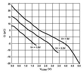
FIGURE 19. CHARGE INJECTION vs SWITCH VOLTAGE
